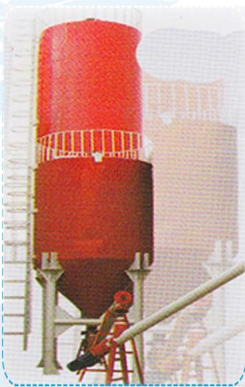
جهت ذخیره سیمان در محل کارخانه بتن سبک از سیلوی که تغذیه خط تولید را به عهده دارد استفاده می شود که با توجه به ظرفیت تولید کارخانه و نیاز پروژه دارای تنوع می باشد.
