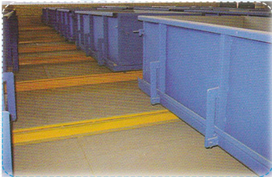
این بخش از تولید سهولت در امر بارگیری جابجایی و انبار کردن و تخلیه قالبها درپرسه خط تولید بتن سبک طراحی و ساخته می شود که کلیه بخش ها بصورت هماهنگ و اتو ماتیک توسط اپراتور ها کنترل می شود.
